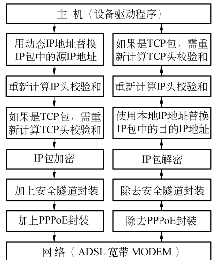
图 6 安全网卡内部 PPPoE 数据包的基本流程 Fig.6 PPPoE data packet flow in safe Ethernet card
